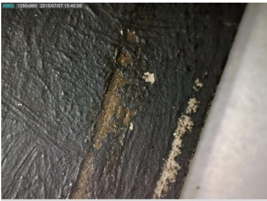
Van links naar rechts: doek, papier, verf, mastiek.
