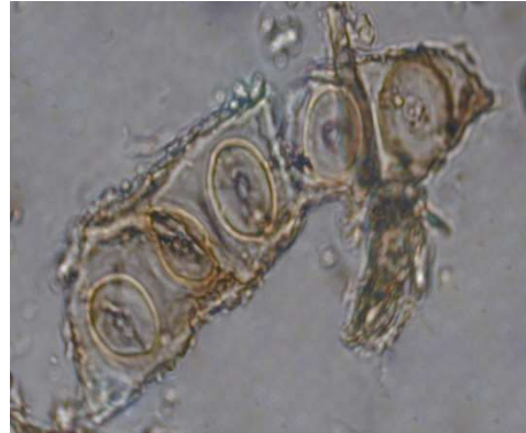
Staal van een spieraam. Radiaal dennenhout met mergstralen loodrecht op de houtvezels (10x40) en hofstippels typisch voor naaldhout (10x60) - © Asperges
